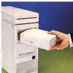
L'inserimento del Data Pac avviene in modo automatico mediante un apposito motore interno. A macchina spenta conviene estrarre il disco dal suo alloggiamento.
